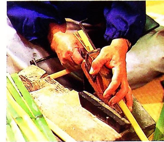
②割(わき) 「切り込み機」で穂先より約10 cmのところまで切り込みを入れる。穂の数は35～45本もあるが、同じ間隔でさいていく。目にも止まらぬ早業で、熟練した職人になると1日500～800本もこなしている。
