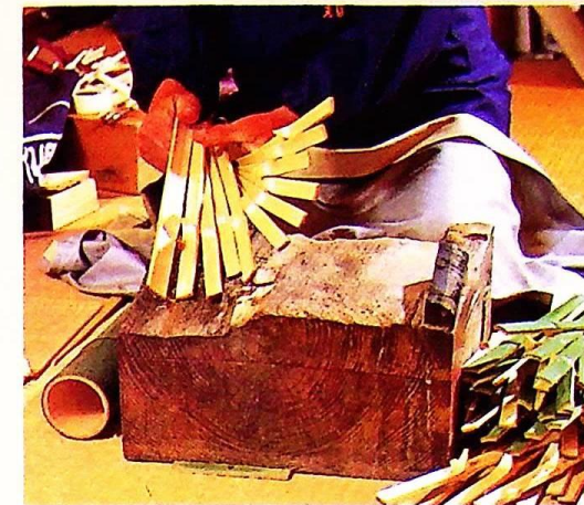
①木取り 素材の竹を平均40～45 cmに切断した管(くだ)をうちわに適した一定の幅に割る。まっすぐ割れる竹の性質を利用した技である。さらに内側の節を削り取る。この作業から手に持った時の心地よい感触が生まれる。
