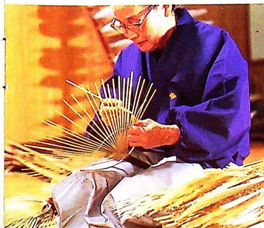
⑥付(つけ) 編んだうちわ骨の弓竹に形をつけ、編みのいびつさを直しながら、左右対称になるように糸をとじつける。昔は「付師」ともいわれた年季のいる作業である。
