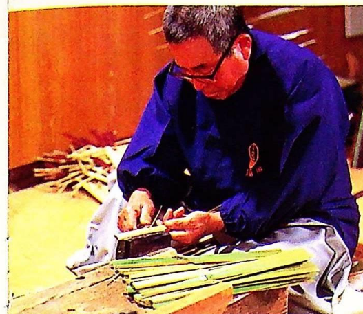
④柄削り 小刀で柄を削り、うちわの種類によっていろいろ加工を施す。柄の部分の仕上げに当たる工程である。
