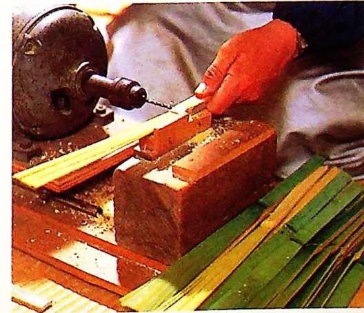
③穴あけ 穴あけ用のきりを使って、鎌(弓竹)を通す穴を節の部分にあける。ここに通す鎌は別の職人の技でつくられる。
