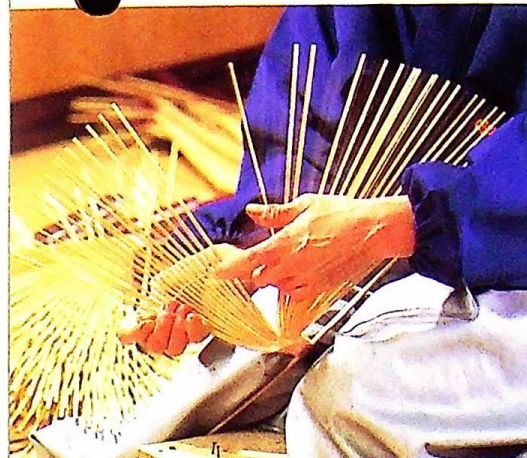
⑤編み 弓竹を通した穂を糸で編む作業。主に女性の仕事で、昔は子供も手伝っていたという。慣れた手付きで器用に編み、1日平均300～400本を編んでいる。
