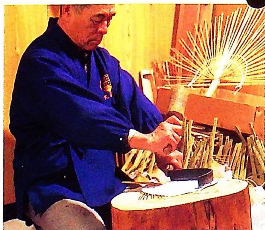
⑧型切り うちわの種類に応じて、満月、玉子型などに穂を仕上げる。たたき鎌を当て、木づちでたたくため「たたき」とも呼ばれる作業である。
